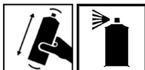
Mischen Sie das Grundierungsspray gut, indem Sie den Behälter 2-3 Minuten lang bei 15-25°C schütteln. Führen Sie einen Sprühversuch durch. Bedecken Sie die isolierte Oberfläche gleichmäßig mit Grundierungsspray aus einem Abstand von 15-20 cm.
