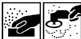
Entfernen Sie Korrosionsstellen gründlich und schleifen Sie sie mit Schleifpapier P320-P500 trocken.
